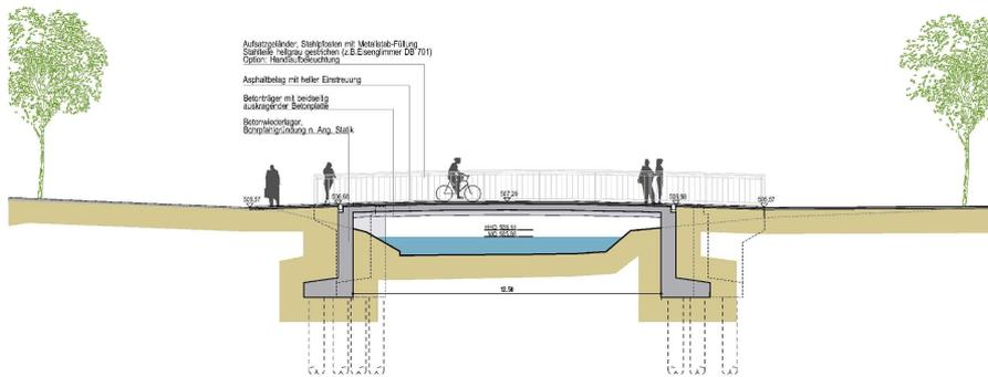
Variante 2 (Vorzugsvariante): Betonbrücke; Längsschnitt M 1/100
