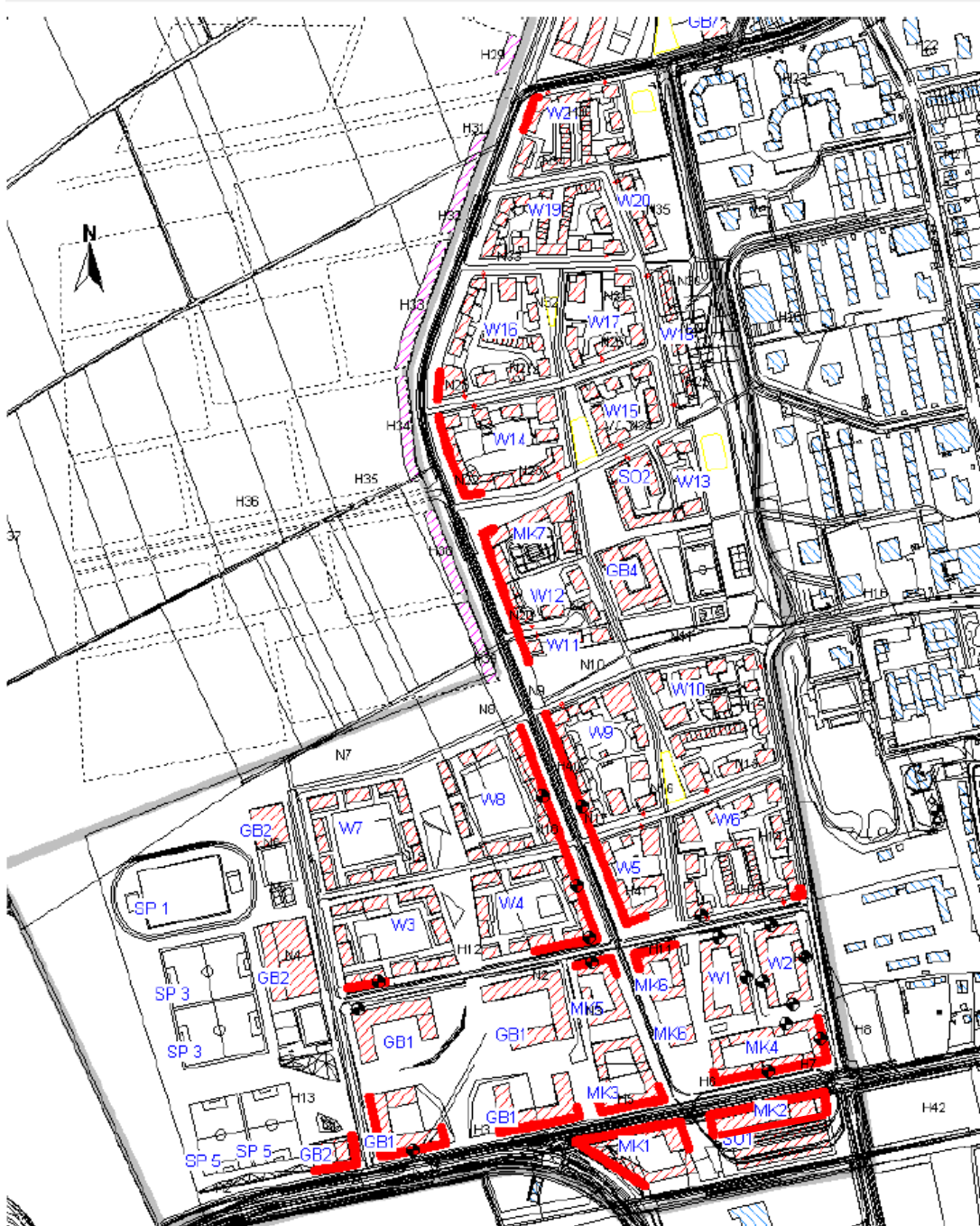
Abb. 9: Fassaden mit mehr als 65/60 dB(A) tags/nachts im Plangebiet (Schalltechnische Untersuchung, Möhler+Partner Ingenieure, Stand August 2014)
