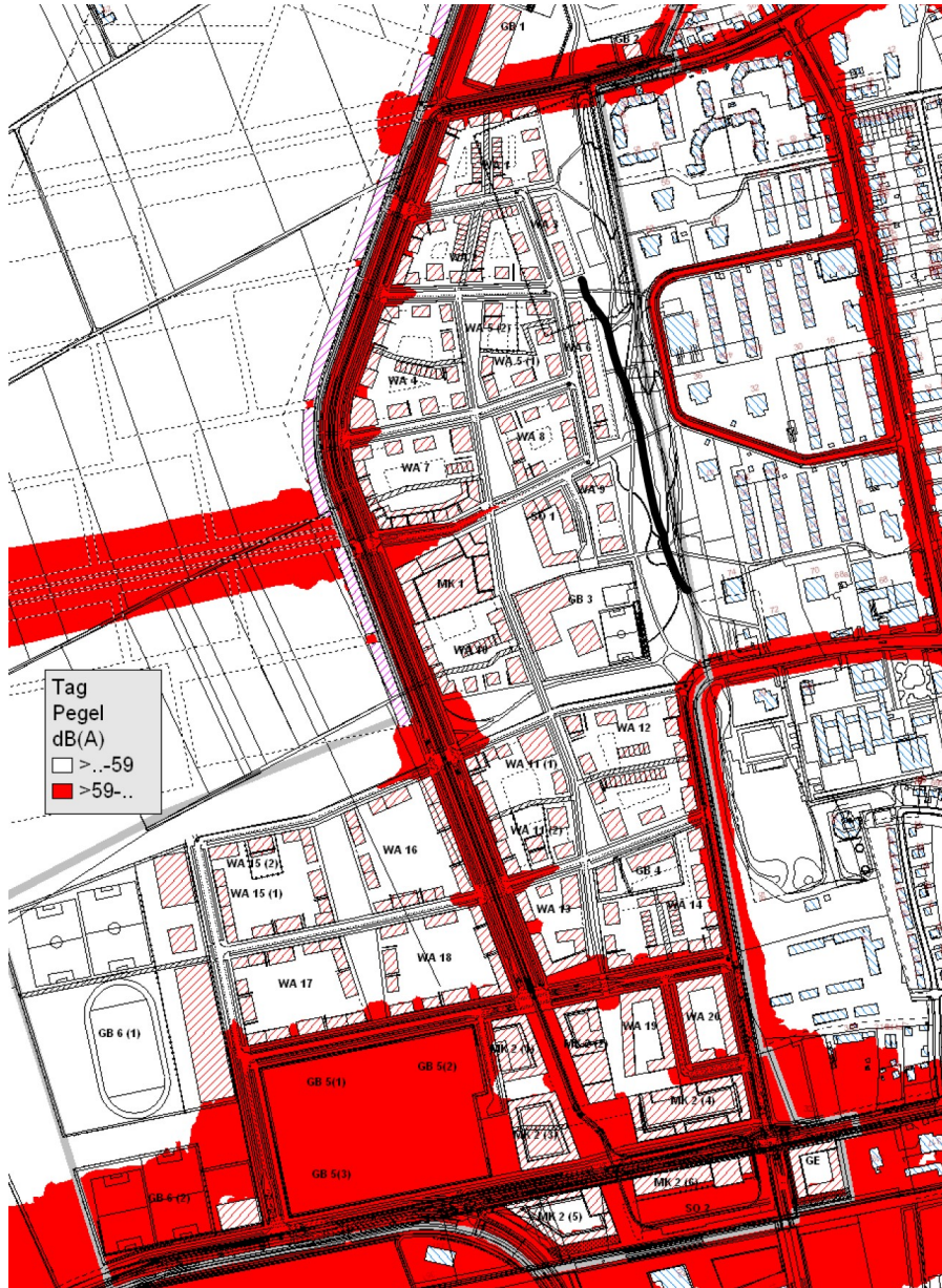
Abb. 10: Fassaden mit mehr als 59 dB(A) tags im Plangebiet (Schalltechnische Untersuchung, Möhler+Partner Ingenieure, Stand Juli 2015)
