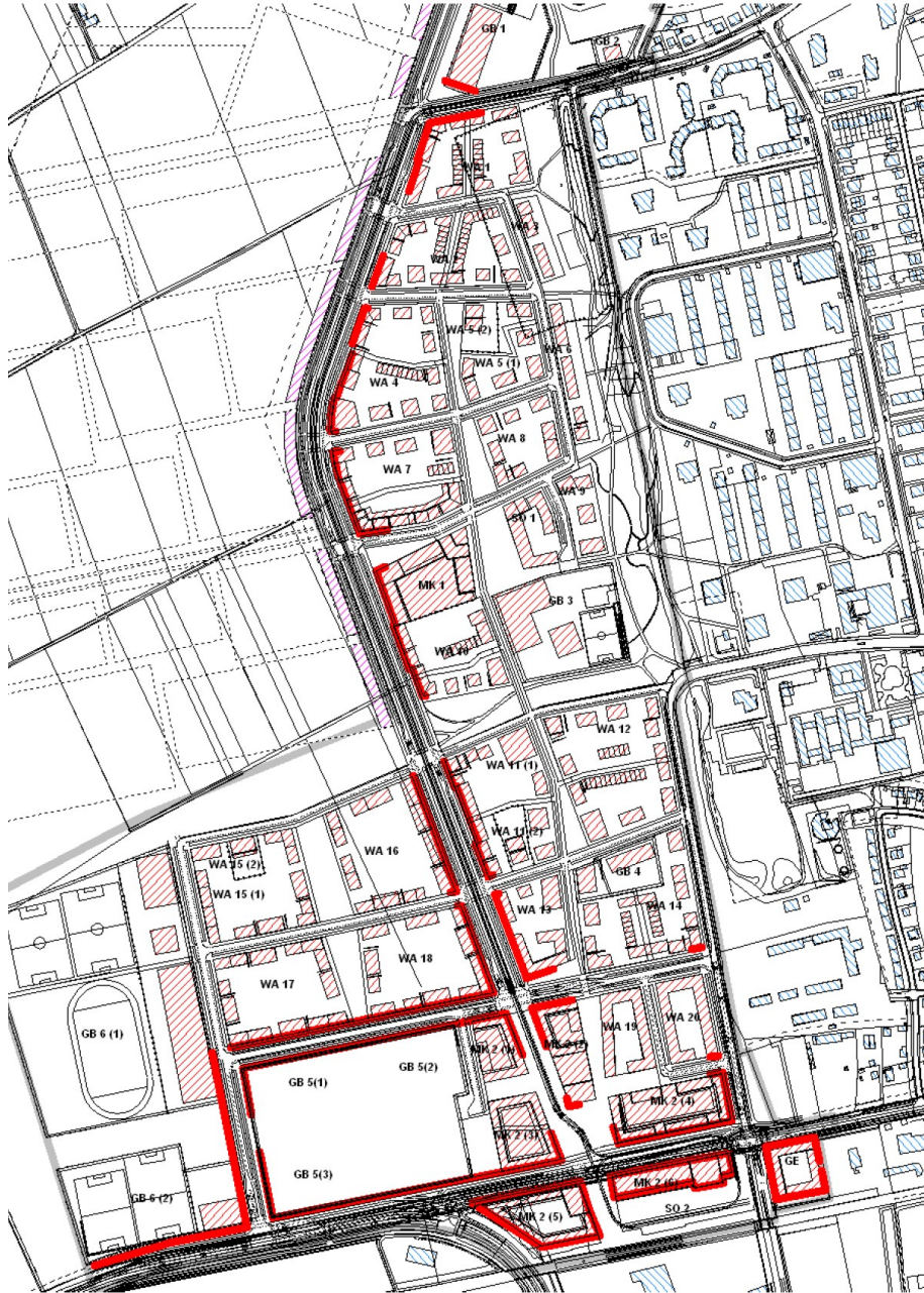
Abb. 9: Fassaden mit mehr als 65/60 dB(A) tags/nachts im Plangebiet (Schalltechnische Untersuchung, Möhler+Partner Ingenieure, Stand Juli 2015)
