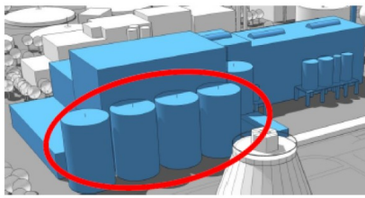
entwässertes KS in Silos
