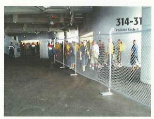
Das System ist einfach und ohne große körperliche Anstrengungen zu bedienen. Der Zaun ist platzsparend auf einer Grundfläche von rund 1 qm verstaut, in der abschließbaren Box befindet sich sämtliches Zubehör. In sehr kurzer Zeit entsteht so einfach und ohne komplizierte Technik ein bis zu 50 m langer robuster Zaun mit einer Höhe von 100 bis 250 cm.
