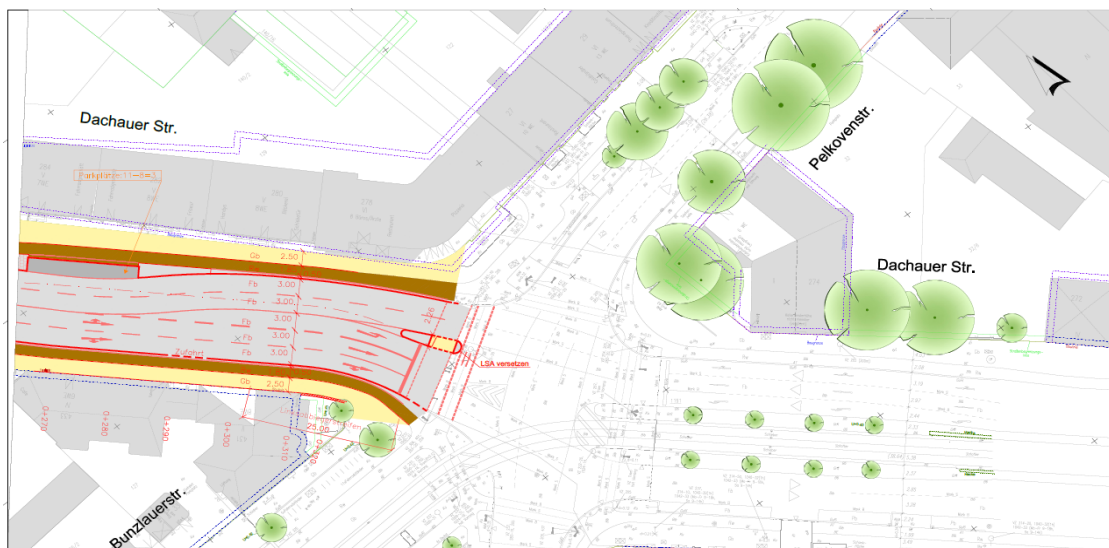
Abbildung 10: Lösung mit verkürztem Linksabbiegestreifen
