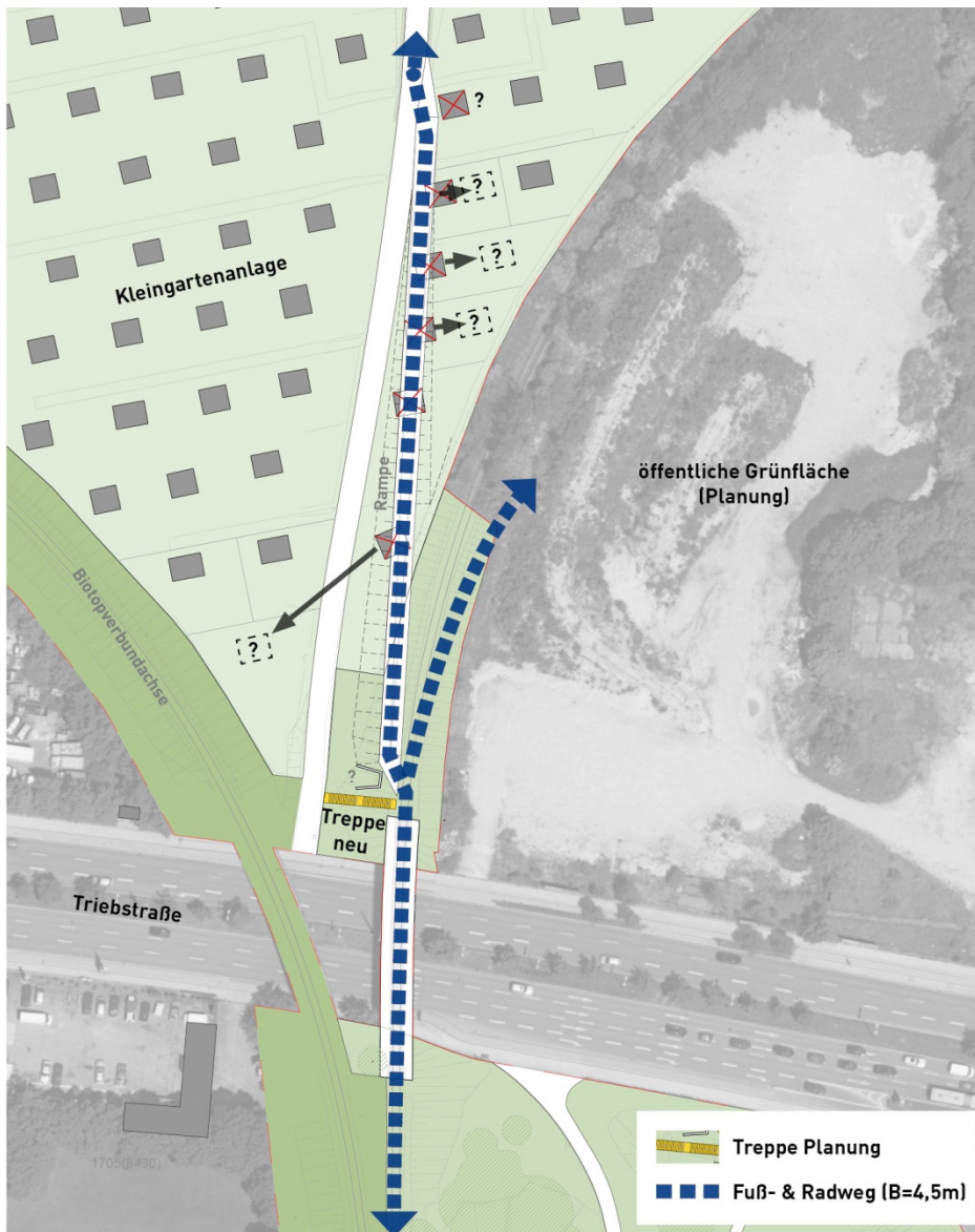
Abbildung 8: Rampe an der Kleingartenanlage (Verkleinerung, Originalmaßstab Lageplan 1:1000)
