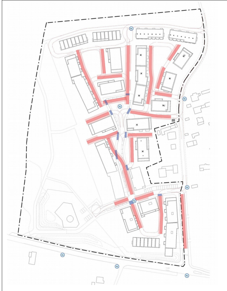
Abb. 7: Schema Feuerweherschließung mit Fahrstrecken und Aufstellflächen
