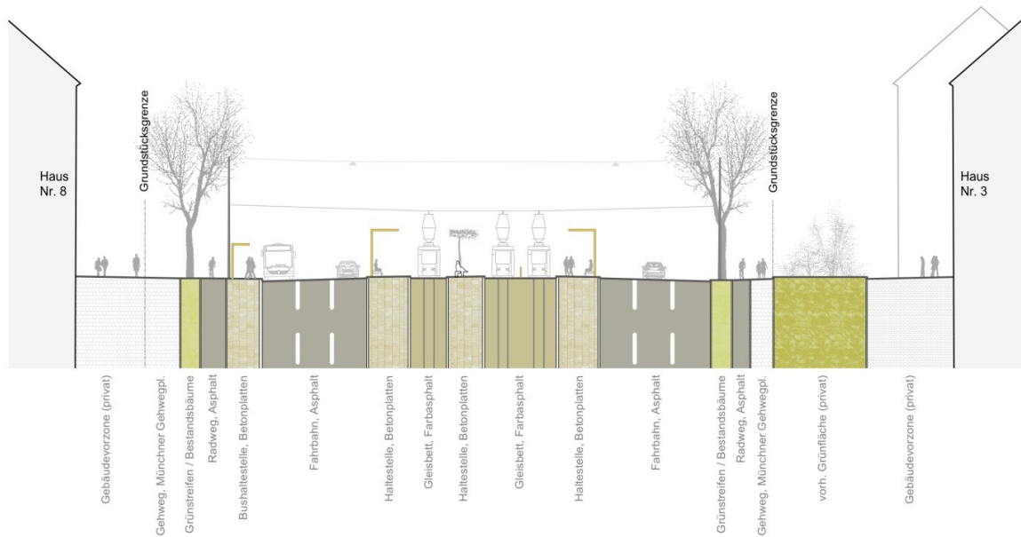
Abbildung 5: Umsetzungsvorschlag Gestaltung Romanplatz, mit Querschnitt von Ost nach West
