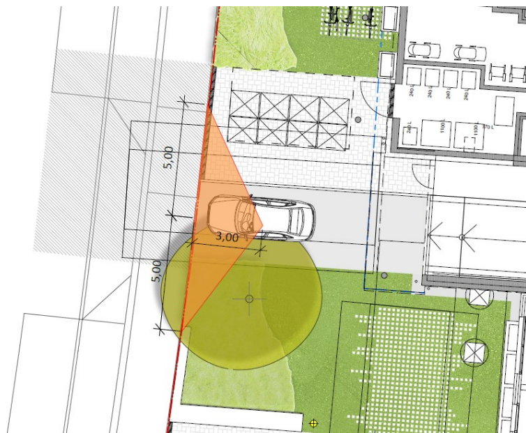
Abbildung 2: Nachweis zum Sichtfeld in der GTGa-Ausfahrt
