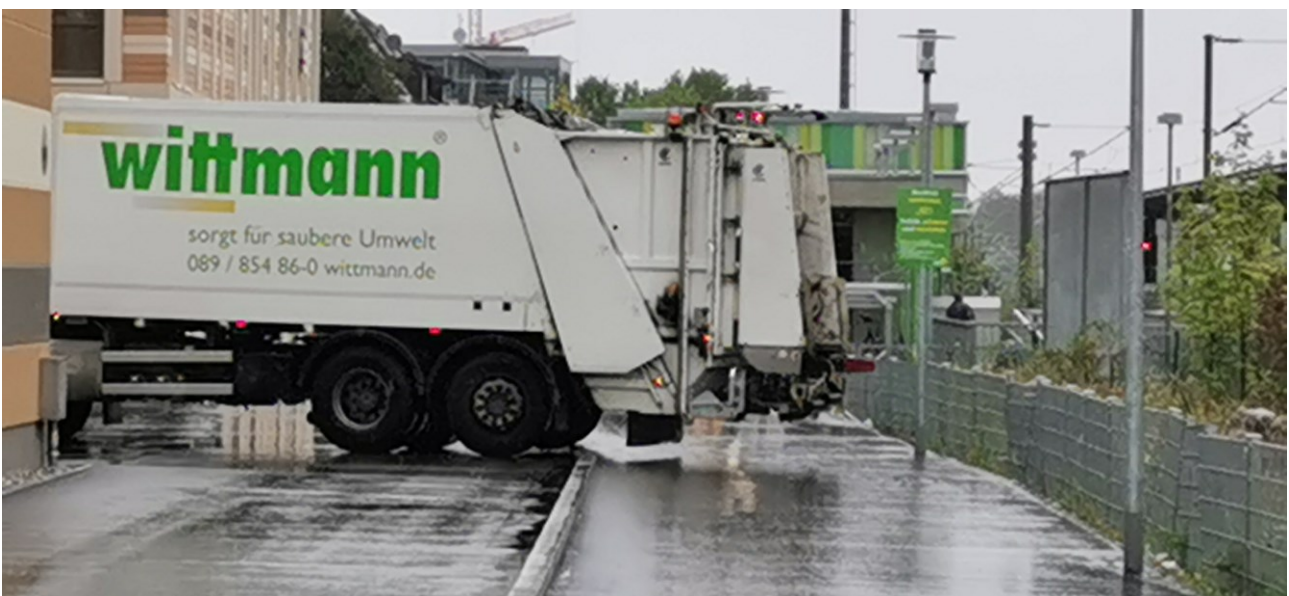
Foto 3: Gefährliche Situation für Fußgänger und Radfahrer, fehlende Einweiser, Bordstein ist kein Hindernis (Lkw hatte vor dem Foto bereits den Bordstein überrollt)
