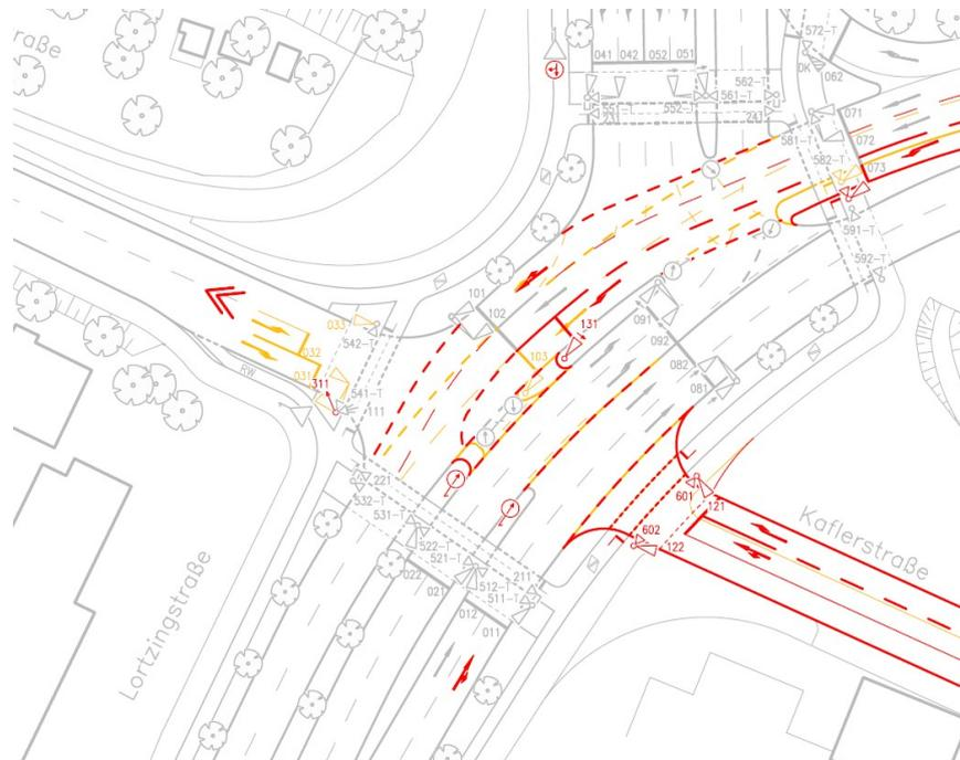
Lageplanausschnitt: mögliche Verkehrsführung Variante 3a während der Bauzeit
