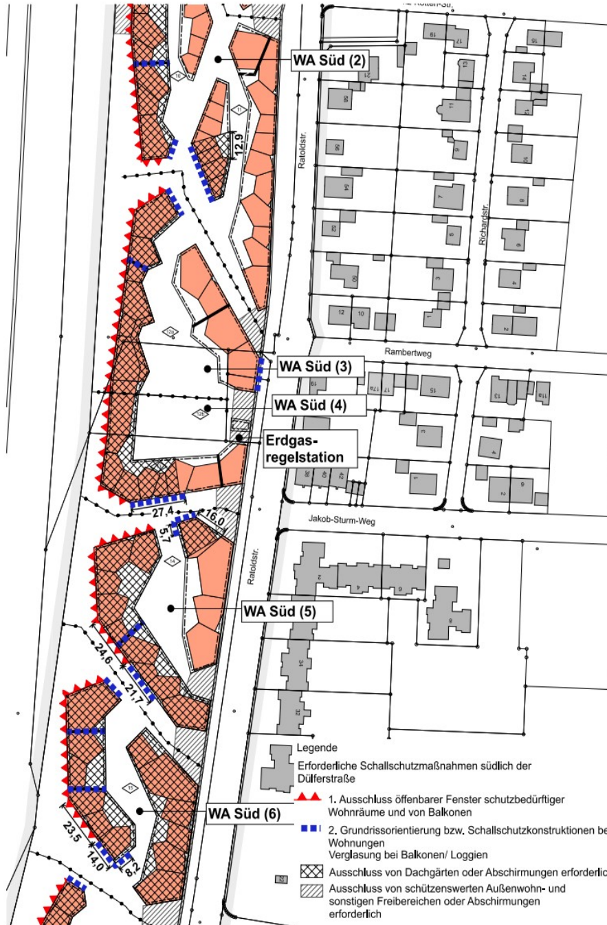
Abb. 3c: Erforderliche Schallschutzmaßnahmen südlich der Dülferstraße WA Süd(2) bis WA Süd(6) zu § 23 Abs. 2 und 3 der Satzung Quelle: DRAGOMIR STADTPLANUNG GmbH auf Basis des Schallgutachtens von Möhler + Partner Ingenieure AG
