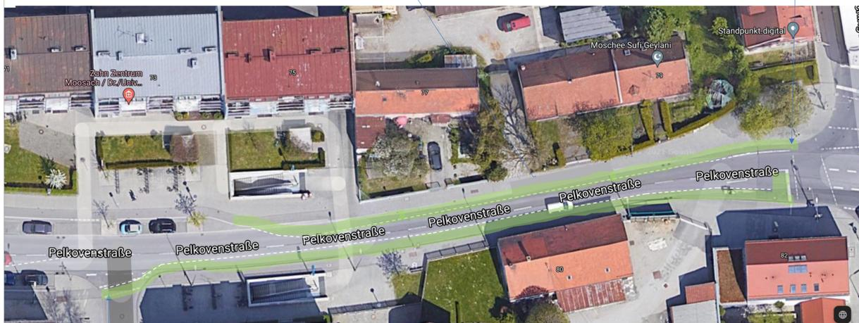
Wechsel auf Fahrbahn; Geteilte Fahrbahn Rad/Motorisiert; Einfärben Radweg gem. Radentscheids-“Grün”; Wartezone vor Ampel
