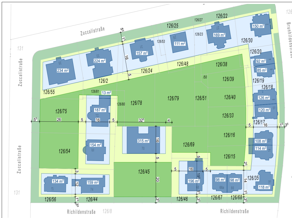
Abb. 3 Schema des Zusammenspiels von Bestand (dunkelblau), überbaubaren Grundstücksflächen (hellblau), Flächen für Nebenanlagen und Flächen mit grünordnungsplanerischen Festsetzungen (grün) © LHM-GeoInfo/eigene Darstellung
