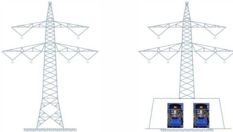
Mit dieser Funktional-Architektonischen Konstruktion der Freileitungsmasten würde sich ein Freiraum schaffen lassen, der bisher für die Nutzung der Trambahn nicht zur Verfügung stand.
