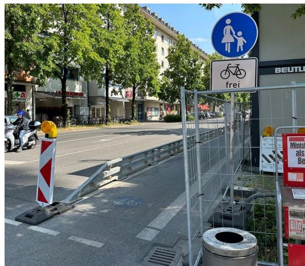
Abbildung 1. Zeichen 239 mit Zusatzzeichen 1022-10 sowie die aufgehobene Bodenmarkierung Zeichen 237 .
