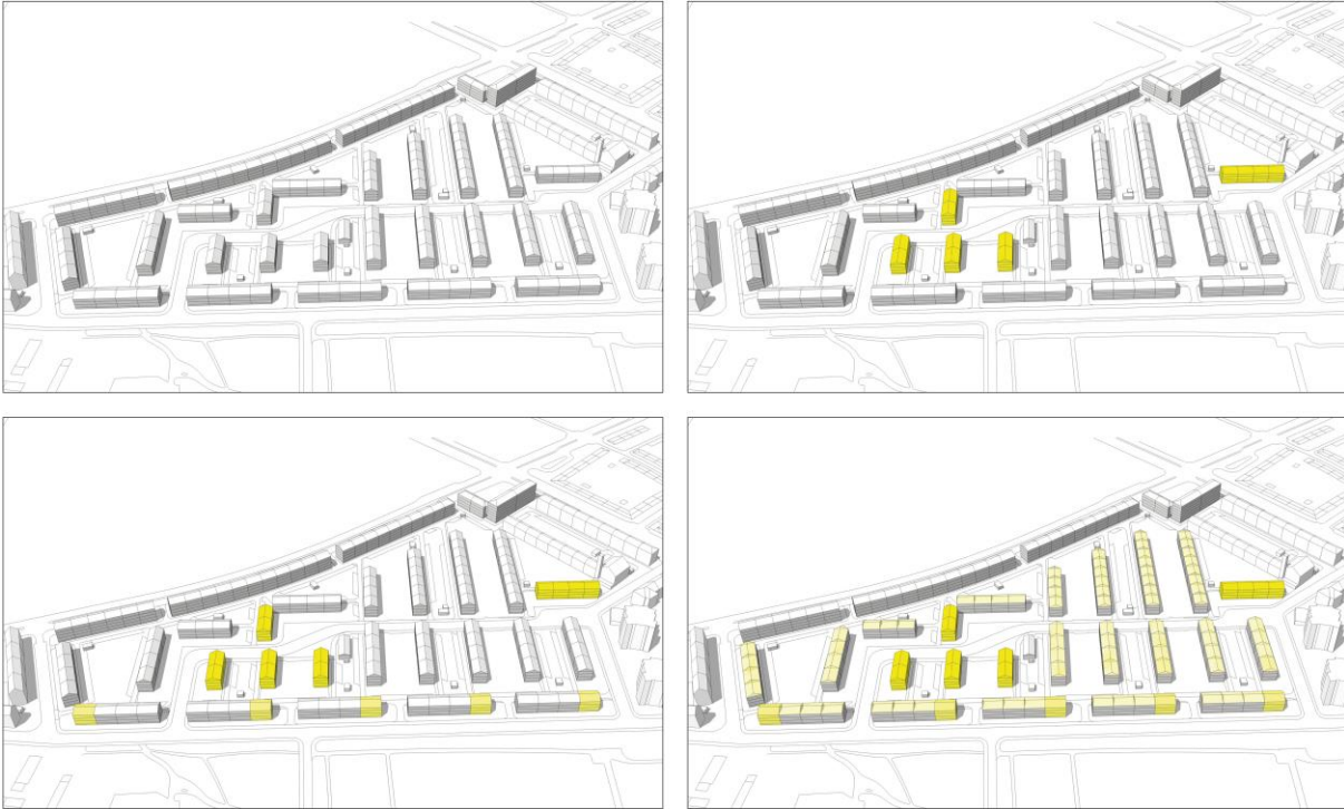
Abbildung 42: Situation Bestand (oben links), Ersatz kleinerer Gebäude zugunsten Zentralität / KiTa und Mobil-Hub (oben rechts), punktuelle Ersatzneubauten zugunsten weiterer Verdichtung an der Wilramstraße - Conclusio C1 (unten links), Potenziale durch Aufstockung (unten rechts), Laux Architekten
