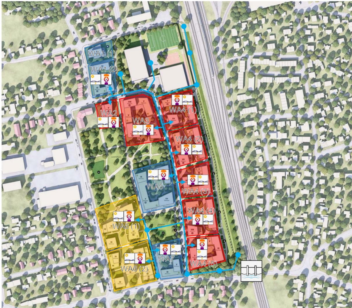
Abb. 5 Nahwärmenetz und dezentrale Wärmeerzeugung – ohne Maßstab,
