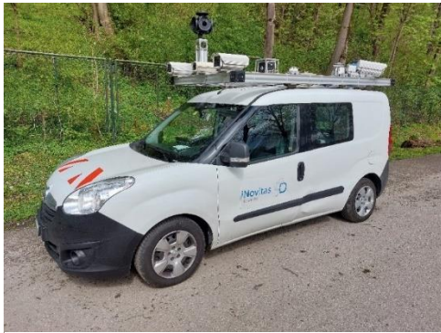
Abbildung 8 Befahrungsfahrzeug der Firma iNovitas
