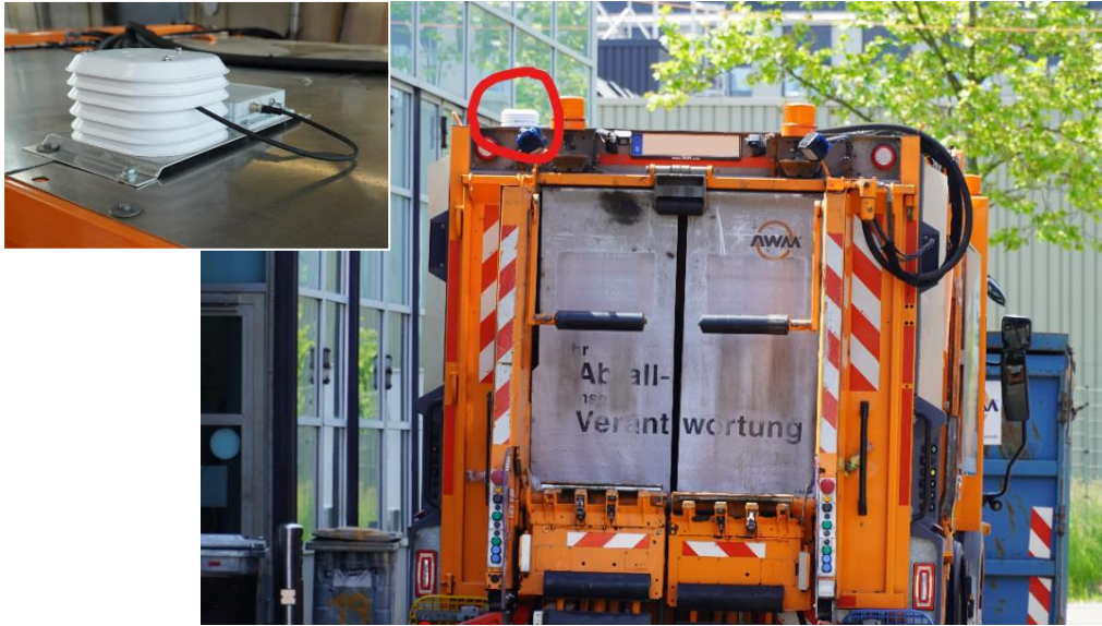
Abbildung 23 Abfallsammelfahrzeug mit montiertem Sensor auf dem Dach Einsatz: Nahaufnahme
