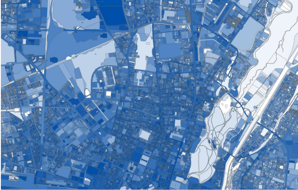
Abbildung 11 Versiegelungsanteil auf Flurstücksebene: Weiß (wenig versiegelt) bis Dunkelblau (stark versiegelt)
