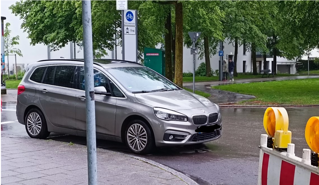
Abbildung 2: Der querende Radweg ist nicht einsehbar; der 5m-Abstand jedoch evtl. sogar eingehalten
