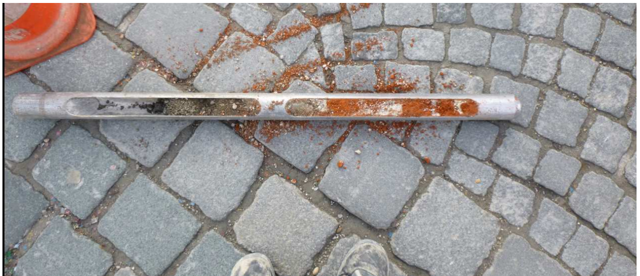
München Viktualienmarkt. Durch Bohrkern können Lage und Tiefe von Kulturschichten und älterer Bebauung exakt nachgewiesen werden. Aufnahme: Firma ReVe.
